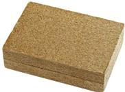
**FiberTherm 160** Fibra di Legno densità  $160 \text{ Kg/m}^3$ . Il pannello FiberTherm in fibra di legno è un isolante termo-acustico multi-uso, prodotto tramite processo a umido. Formato pannello 1350x600 mm. Disponibile in spessori da 20 a 200 mm.
