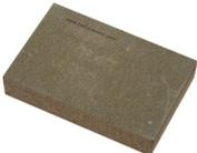
**BetonWood N** Il pannello BetonWood, ad alta densità ( $1350 \text{ Kg/m}^3$ ), realizzato in conglomerato cementizio tipo Portland e fibra di legno di Pino scortecciato. Caratteristiche termodinamiche: coefficiente di conduttività termica  $\lambda=0,26 \text{ W/mK}$ , calore specifico  $c=1,88 \text{ KJ/Kg K}$ , coefficiente di resistenza alla penetrazione del vapore  $\mu=22,6$  e classe di reazione al fuoco A2-fl-s1, secondo la norma EN 13501-1.
