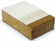
**FiberTherm Protect** Pannello in fibra di legno intonacabile disponibile nelle densità 190-230-265 Kg/m<sup>3</sup> con un'elevata resistenza a compressione e idrorepellente per la realizzazione di cappotti termici certificati. Conduttività termica dichiarata  $\lambda_{D}$  [W/(m\*k)] 0,042÷0,048. Disponibile nei formati: 2.800x1.250 mm, 2.625x1.175mm, 2.600x1.250 mm, 1.350x600mm, 1.200x400 mm. Spessori da 20 a 160 mm.
