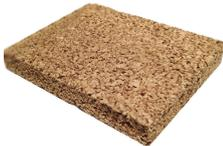
**CorkPanels** Pannello in sughero biondo avente densità 150÷160 Kg/m<sup>3</sup> atossico, biologicamente puro, inalterabile, impermeabile, traspirante, resistente, adatto alla realizzazione di cappotti termici certificati. Conduttività termica dichiarata  $\lambda_D$  [W/(m\*k)] 0,041. Disponibile nel formato 1.000x500 mm. Spessori da 3 a 100 mm.
