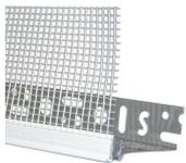
**BetonDripStarter PVC** Profilo di partenza in pvc con rete termosaldata in fibra di vetro 165 gr/mq certificata ETAG004. Collegamento a tenuta tra la base di partenza e la rasatura armata. Interrompe lo scorrimento dell'acqua evitando infiltrazioni. Impedisce le fessurazioni nella zona di zoccolatura. Dimensioni 2,5x0,125 m. 25 pezzi per confezione.
