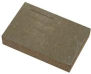
**BetonWood N** Il pannello BetonWood, ad alta densità (1350 Kg/m<sup>3</sup>), è realizzato in conglomerato cementizio tipo Portland e fibra di legno di Pino scortecciato. Ha le seguenti caratteristiche termodinamiche: coefficiente di conduttività termica  $\lambda=0,26$  W/mK, calore specifico  $c=1,88$  KJ/Kg K, coefficiente di resistenza alla penetrazione del vapore  $\mu=22,6$  e classe di reazione al fuoco A2-fl-s1, secondo la norma EN 13501-1.
