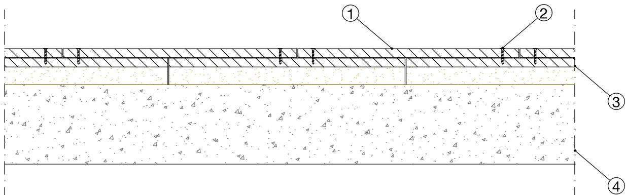
1. **Pannello in cementolegno BetonWood** è realizzato in cementolegno Portland e fibre di legno, ha densità  $1350 \text{ kg/m}^3$  ed una elevatissima resistenza a compressione pari a  $9.000,00 \text{ Kpa}$ . Questo particolare pannello garantisce un'ottima soluzione per interventi mirati ad ottenere alti livelli di sfasamento termico, grazie alla sua alta densità che lo rende adatto anche per massetti a secco autoportanti, pavimenti radianti e strutture di irrigidimento.
