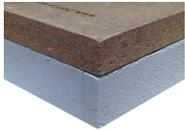
**BetonStyr XPS** Il pannello isolante rigido BetonStyr XPS in cementolegno e polistirene estruso accoppiati è costituito da due strati accoppiati in fabbrica: un pannello in cementolegno BetonWood ad alta densità ( $1350 \text{ Kg/m}^3$ ) ed elevatissima resistenza a compressione (9.000,00 Kpa) realizzato in conglomerato cementizio tipo Portland e fibra di legno di Pino scortecciato, e uno strato costituito da un pannello in polistirene estruso.
