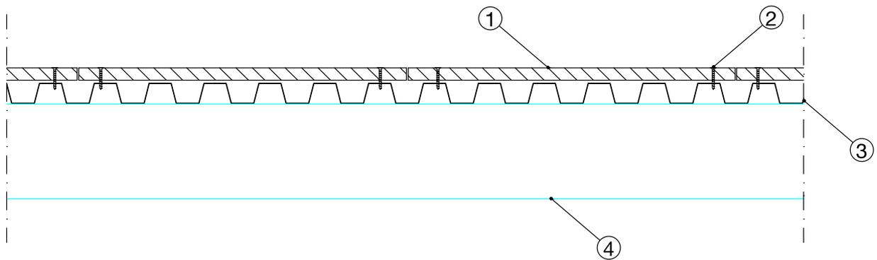
1. **Pannello in cementolegno BetonWood** è realizzato in cementolegno Portland e fibre di legno, ha densità  $1350 \text{ kg/m}^3$  ed una elevatissima resistenza a compressione pari a  $9.000,00 \text{ Kpa}$ . Questo particolare pannello garantisce un'ottima soluzione per interventi mirati ad ottenere alti livelli di sfasamento termico, grazie alla sua alta densità che lo rende adatto anche per massetti a secco autoportanti, pavimenti radianti e strutture di irrigidimento.
